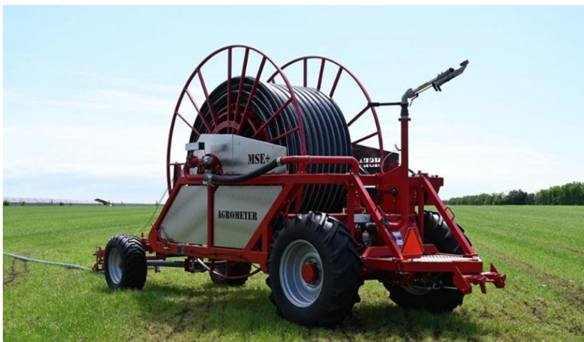
Figur 23. En självindragande maskin bär både slang och spridare på maskinen. När maskinen dras ut läggs slangen längs spåret och vid spridningen följer maskinen slangen hela vägen tillbaka. Därmed kan spridaren följa fältkonturer eller runda hinder i fält. Källa: www.agrometer.dk
