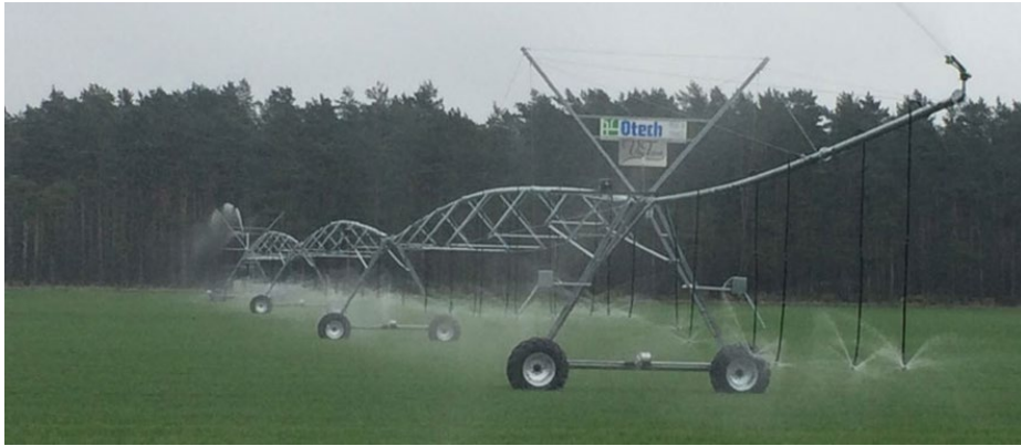
Figur 26. Exempel på ramp för Pivot/Lateral bevattningsanläggning med spridare fördelade längs rampen. Många små spridare medger låga tryck och mindre vindkänslighet. Källa: www.vibyteknik.se
