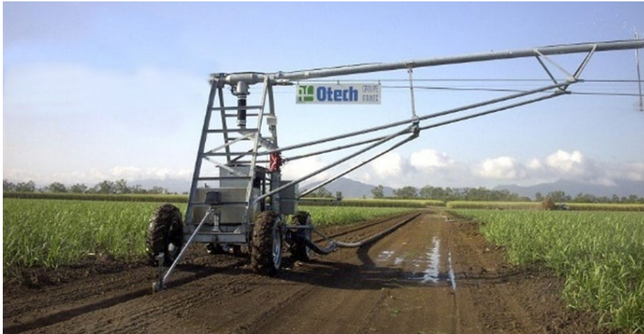
Figur 27. En linjärmaskin kan förses med vatten genom slang som släpas med längs fältkanten. Källa: www.vibyteknik.se
