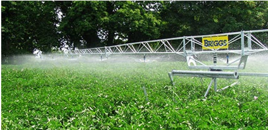
Figur 25. Med en spridarramp kommer fördelningen av vatten att ske närmre grödan och från många spridarmunstycken. Det gör att risken för negativ inverkan av vinden minskar, liksom energiförbrukningen genom behovet av lägre pumptryck. Källa: www.ostorpsbevattning.se
