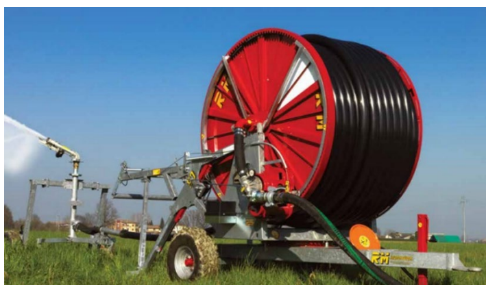
Figur 22. Vanligast förekommande bevattningsmaskiner placerar slangtrumman vid fältkanten. Spridaren dras rakt ut i fältet och vid spridningen drar slangtrumman tillbaka spridaren med hjälp av vattentrycket och rullar upp slangen på trumman. Källa: www.vibyteknik.se
